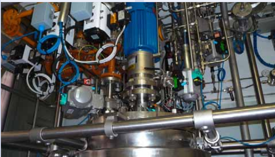
Reactor vessel head with automated valves, Hastelloy, ATEX Reaktor Aufbau mit automatisierten Ventilen, ATEX
