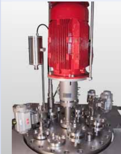
Powerful stirrer drive with 3600 Ncm torque magnetic coupling Rührwerk mit 3600 Ncm Magnetkupplung für hohes Drehmoment
