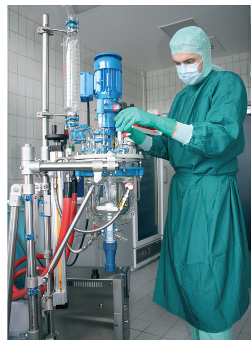
Abb. 2: Büchi Minipilot 2 nach für GMP/FDA konformen Betrieb in den nach §14 AMG zugelassenen Herstellungsräumen der Apotheke des Universitätsklinikums Erlangen.
